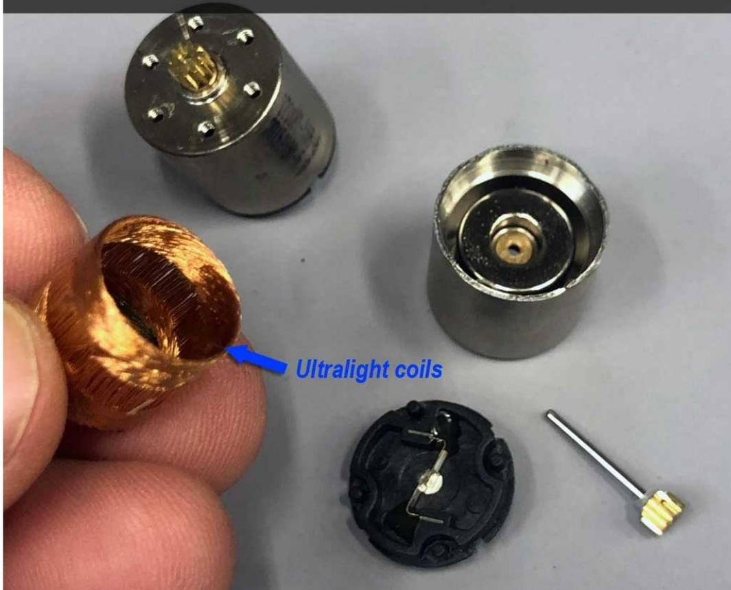
Der Hauptvorteil ist, dass diese Wicklungen ohne Kern einfach weniger wiegen. Tatsächlich ist ihre Masse nur ein Bruchteil der Masse des Eisenkerns in einem Gleichstrommotor, was bedeutet, dass es einfacher ist, ihn zu beschleunigen und abzubremesen.
