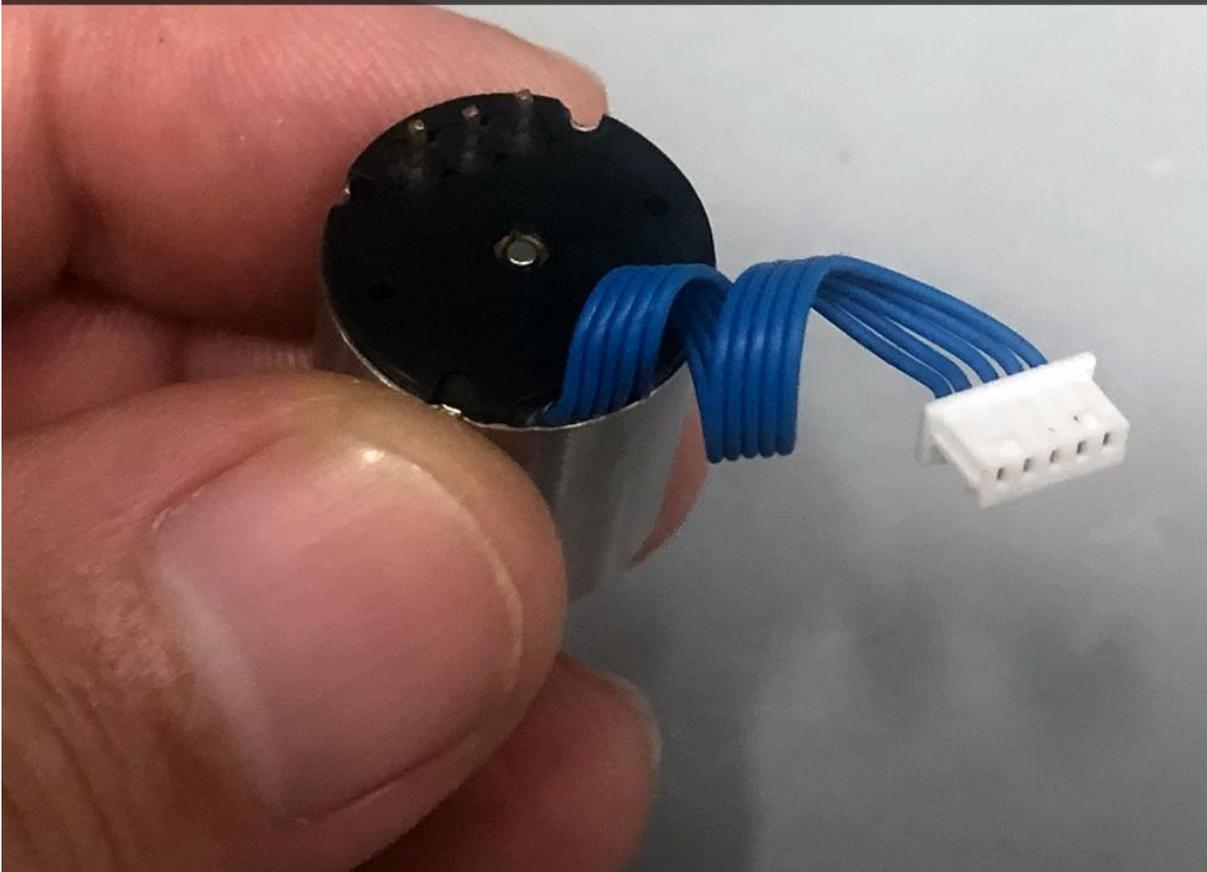
Beachten Sie als nächstes, dass bürstenlose Motoren ebenfalls mit einem Dorn gewickelt werden. Der Punkt ist, dass bürstenlose Motoren genau wie kernlose Motoren auch für Hochleistungsservos verwendet werden, da sie schneller beschleunigen / verzögern als Eisenkernmotoren
